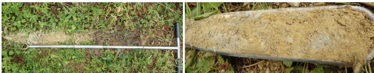
Figure 20 : Sondage 357 : carottage montrant la transition brutale de sol, et zone de pseudogley
